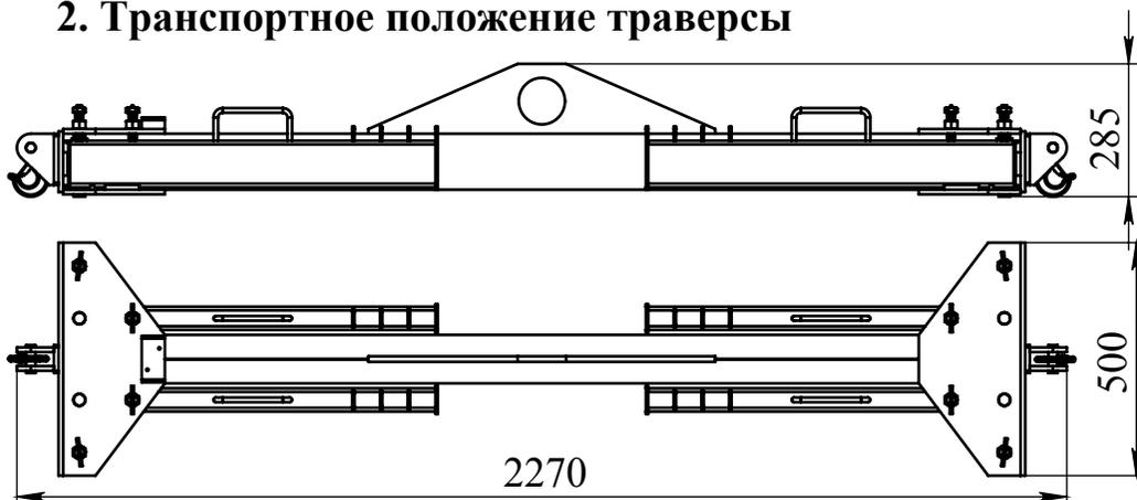
В транспортном положении траверса может быть использована в качестве линейной балки с центральной пластиной подвески и крюками на краях для подъема грузов массой до 2500 кг.
