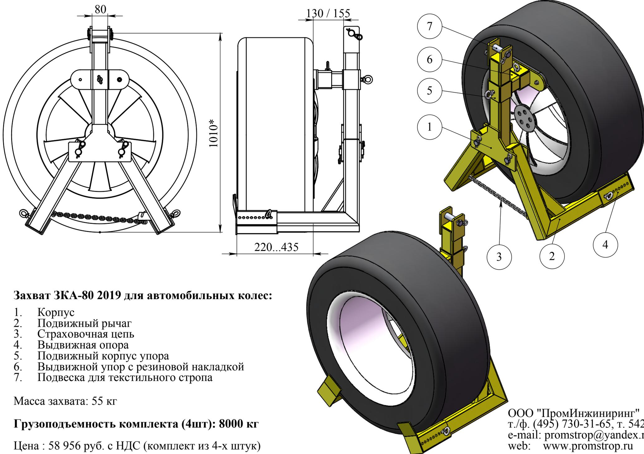
**Захват ЗКА-80 2019 для автомобильных колес:**
